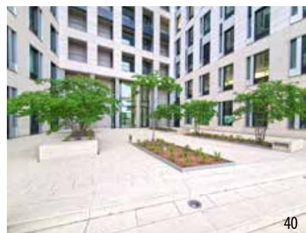
Helle Oberflächen an Fassaden und im Freiraum reduzieren die Aufheizung
