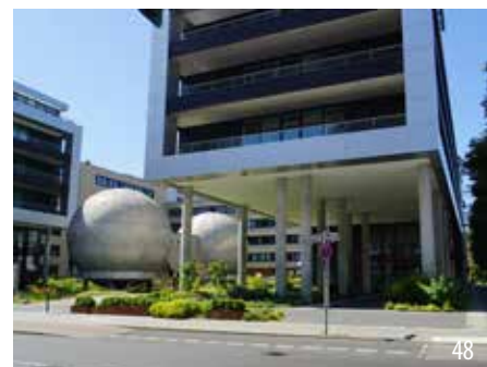
Architektur auf Stelzen ermöglicht Verschattung und Durchlüftung
